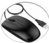
Mouse adalah salah unit masukan (input device). Fungsi alat ini adalah untuk perpindahan pointer atau kursor secara cepat. Mouse mulai digunakan secara maksimal sejak
