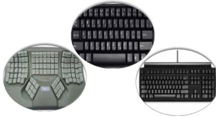
Keyboard merupakan alat input yang paling umum digunakan, input dimasukkan ke alat proses dengan cara mengetikkan lewat penekanan tombol yang ada di keyboard. Dari beberapa jenis keyboard yang beredar dipasaran (khususnya Indonesia) adalah Jenis American standard, British standard, dan Japan.(Maulana 2017)
