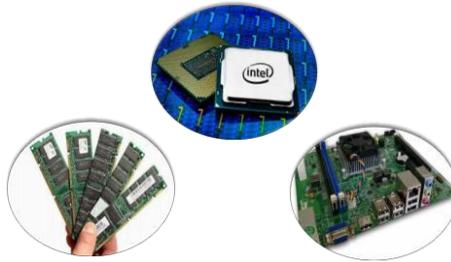
Perangkat pemrosesan digunakan untuk memproses atau mengolah data-data pada komputer. Perangkat ini dapat dikatakan juga sebagai otak dari sebuah komputer, karena merupakan perangkat yang penting untuk melakukan proses terhadap data-data yang dimasukan. Contohnya sebagai berikut:
