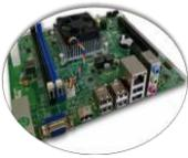
Motherboard atau Papan induk adalah papan sirkuit tempat berbagai komponen elektronik saling terhubung, motherboard biasa disingkat dengan kata mobo. Pada motherboard inilah perangkat keras seperti Harddisk, ram, prosesor, kartu grafis, dan perangkat keras lain dihubungkan.
