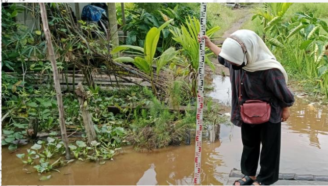
Mengukur kedalaman saluran eksisting anak sungai di parit 7 Jl Suhada II menggunakan rambu ukur
