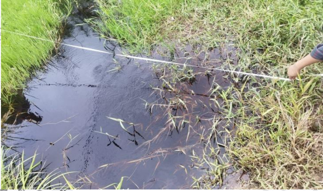
Mengukur lebar atas saluran eksisting anak sungai di parit 7 Jl Suhada II menggunakan meteran
