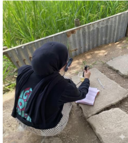
Mengukur kualitas air menggunakan DO Meter
