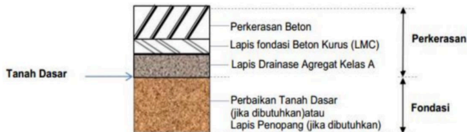
Gambar 2. 2 Lapisan Perkerasan di Tanah Asli (Sumber: Mohammad Rafii Tiara Manggala, 2022))
