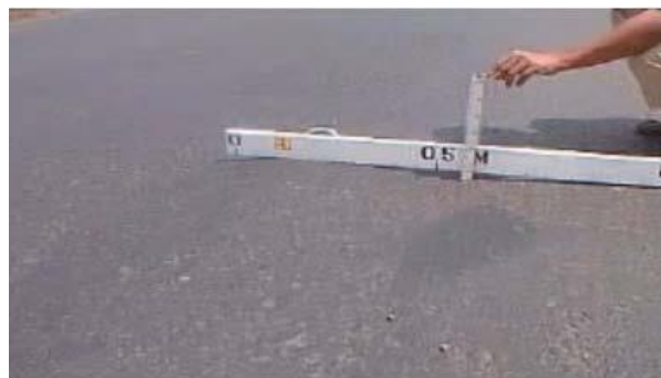
Gambar 2.16 Alur ( Rutting ) Sumber: Fitri (2022)
