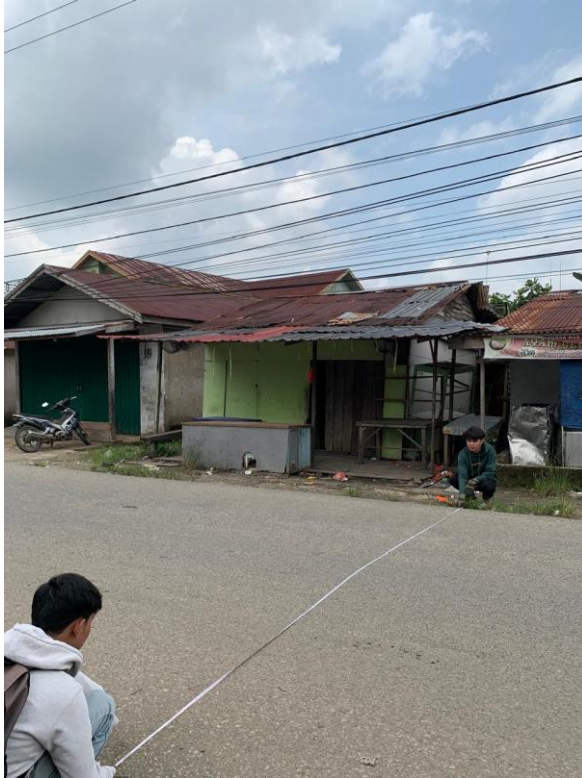
Gambar.1 Pengukuran Lebar Jalan (Sumber : Hasil Analisis, 2026)
