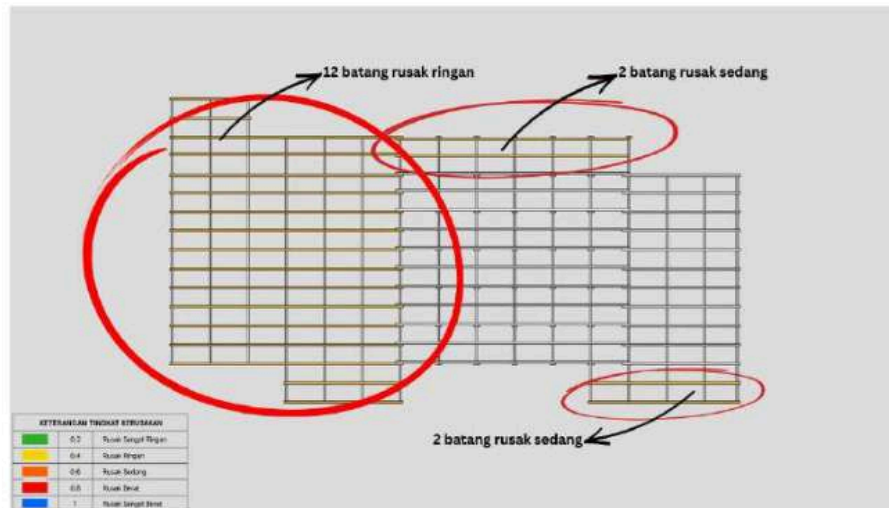
Gambar 4. 17 Tampak Kerusakan Gelagar
