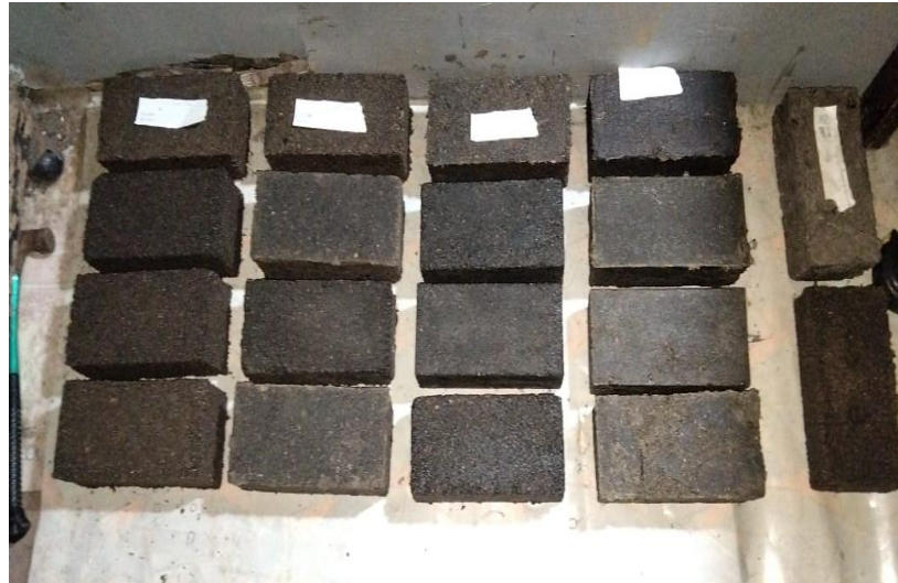
Gambar 4. 10 Proses Pendinginan Benda Uji di Suhu Ruang
