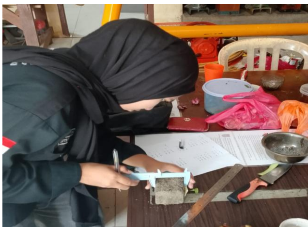
Gambar 4. 12 Proses Pengukuran Dimensi Benda Uji
