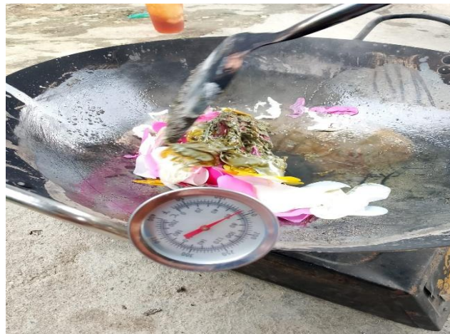
Gambar 4. 6 Proses Awal Pelelehan Limbah Plastik LDPE
