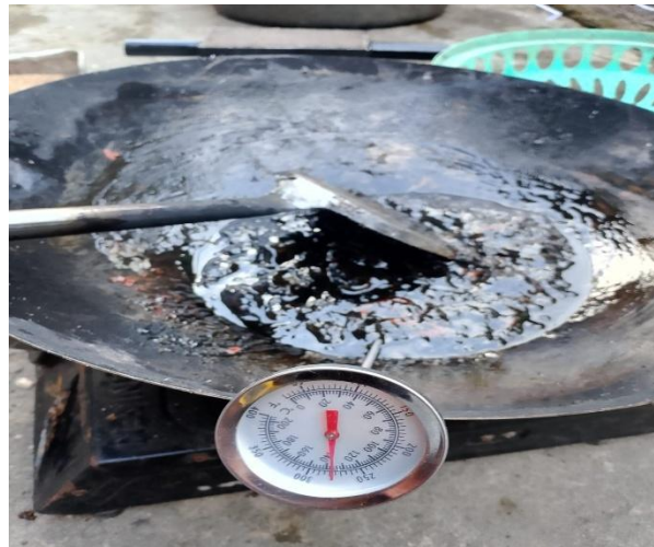
Gambar 4. 7 kondisi Limbah Plastik LDPE Setelah Meleleh
