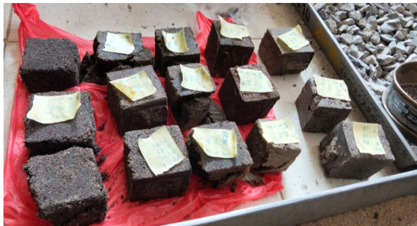
Gambar 4. 17 Kondisi Benda Uji Paving Interlock Setelah Pengujian Kuat Tekan Umur 14 Hari
