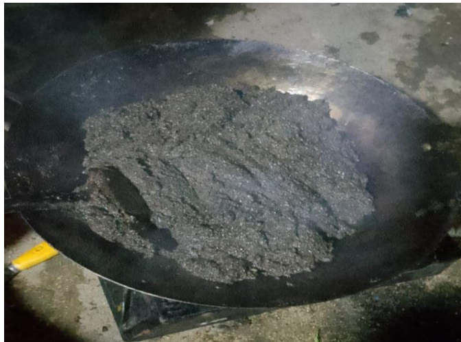
Gambar 4. 8 Campuran Agregat Halus dan Limbah Plastik LDPE yang Telah Homogen
