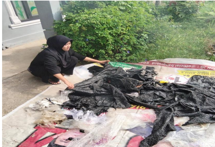
Gambar 4. 4 Proses Pengeringan Limbah Plastik LDPE
