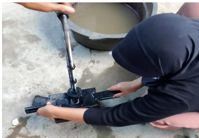
Gambar 4. 9 Proses Pencetakan Paving Interlock
