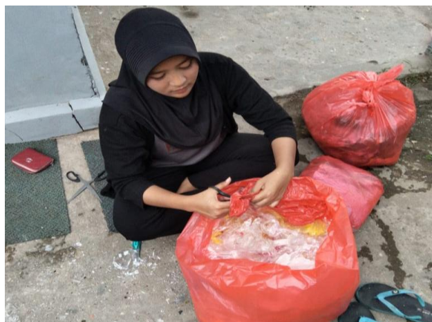
Gambar 4. 5 Proses Pemotongan Plastik LDPE
