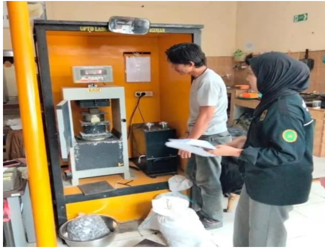
Gambar 4. 14 Proses Pengujian Kuat Tekan
