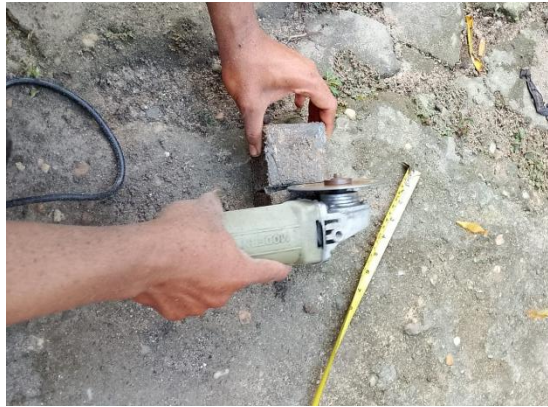
Gambar 4. 11 Proses Pemotongan Benda Uji
