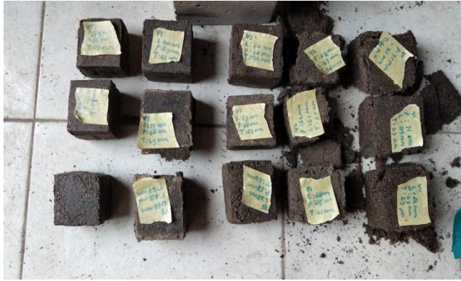
Gambar 4.15 Kondisi Benda Uji Umur 7 Hari Setelah Pengujian
