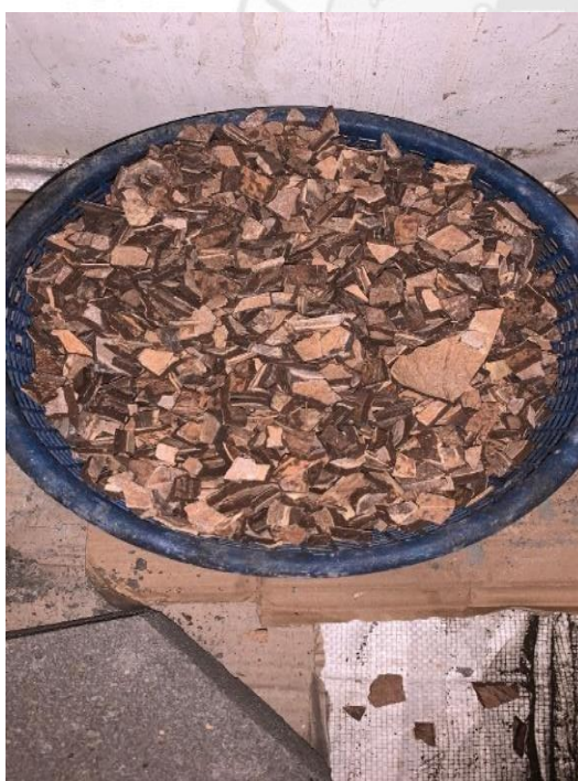
Cacahan Tempurung Kelapa sebagai bahan tambahan dalam pembuatan paving block.
