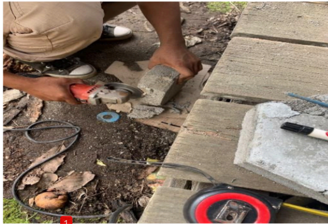
Gambar 4. 2 Pemotongan Benda Uji
