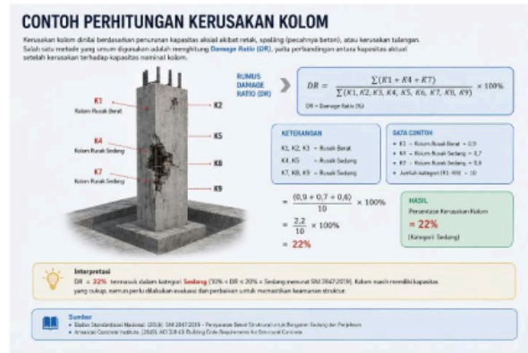
Gambar 3. 14 Contoh Perhitungan Kerusakan Kolom
