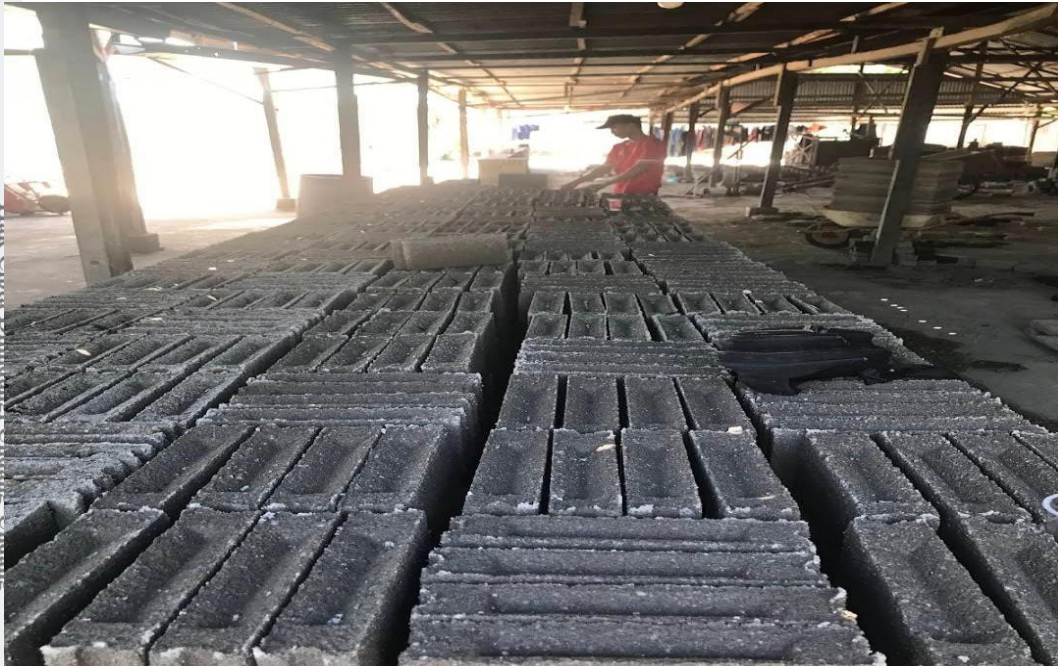
Gambar 1. Proses curing (Pengeringan) Produk Beton
