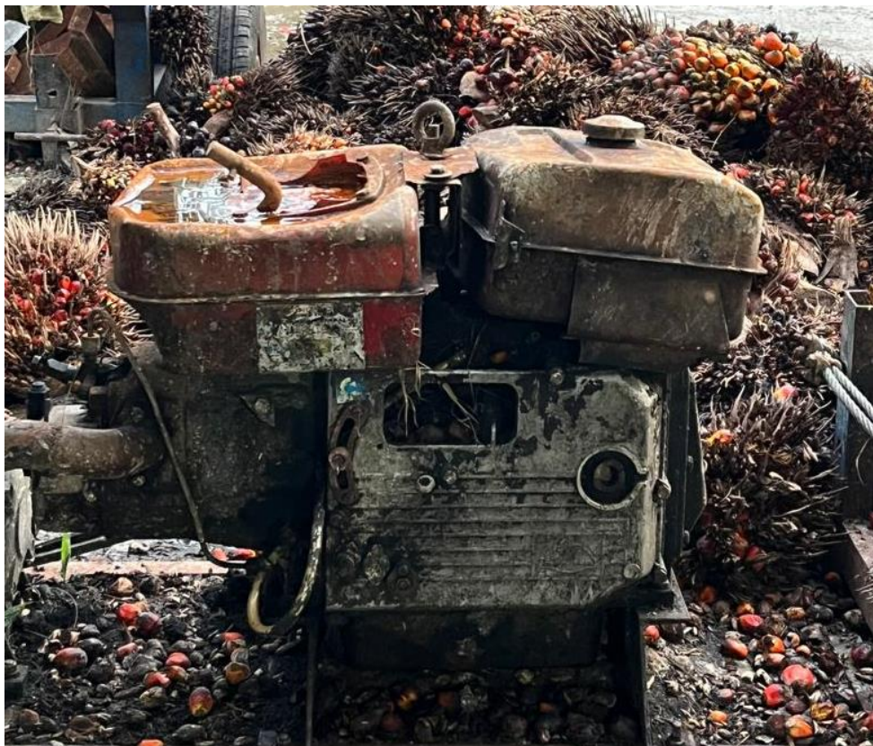
Gambar Mesin Dompeng Tipe S195 Sebagai Penggerak Conveyor
