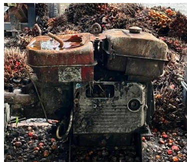
Gambar 4. 6 Mesin Dompeng Tipe S 195 sebagai Penggerak Conveyor
