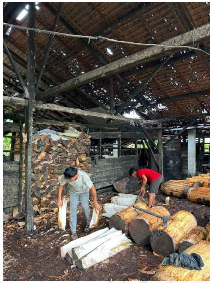
Gambar 5. Proses Pembelahan Batang Sagu
