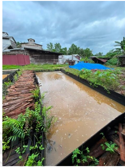
Gambar 10. Tahap Akhir Proses Pengendapan Pati Sagu
