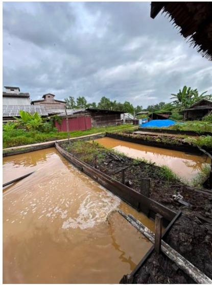
Gambar 9. Proses Pengendapan Pati Sagu
