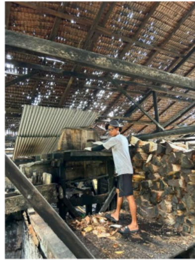
Gambar 6. Proses Pemarkutan Batang Sagu
