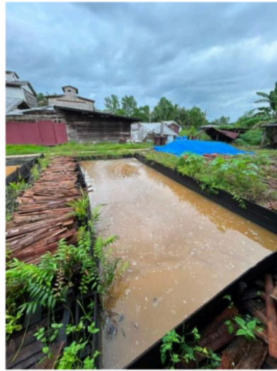
Gambar 10. Tahap Akhir Proses Pengendapan Pati Sagu
