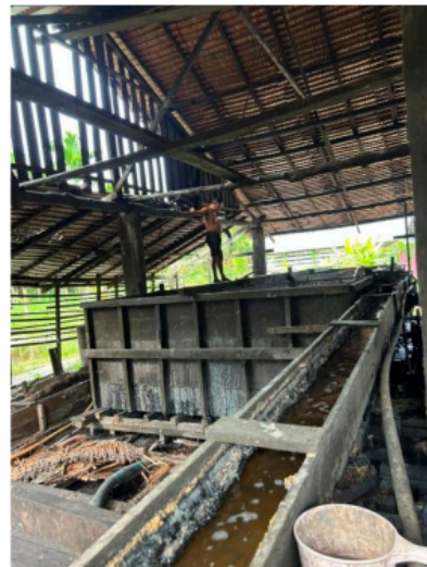
Gambar 8. Proses Pengaliran Pati Sagu
