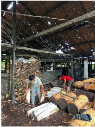
Gambar 5. Proses Pembelahan Batang Sagu
