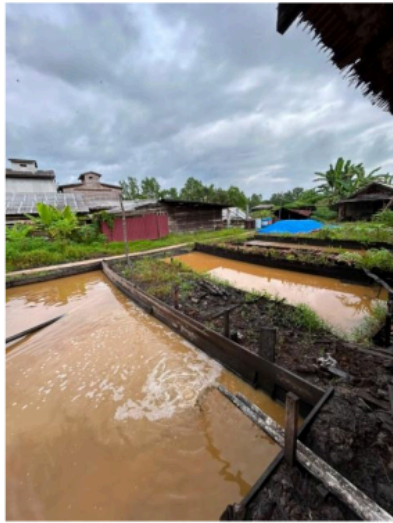
Gambar 9. Proses Pengendapan Pati Sagu
