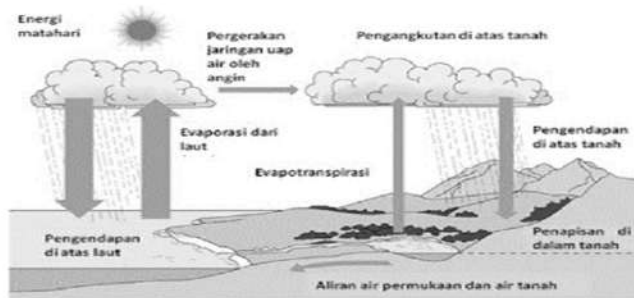
Gambar 2.3 Siklus Hidrologi (Sumber : Suripin, 2004)
