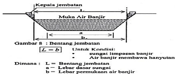
Gambar 2. 4 Bentang Jembatan Untuk Sungai Limpasan Banjir
